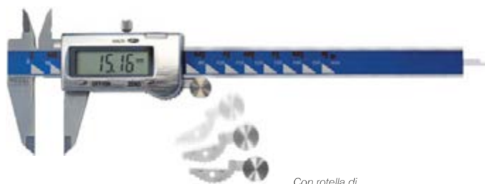
Con rotella di posizionamento rimovibile
