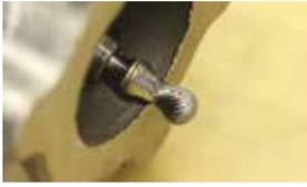
Fresa rotativa a raggio a doppio taglio, in carburo di tungsteno sinterizzato, di elevata qualità e durata. La geometria speciale a taglienti invertiti e il punto d'intersezione tra le due forme dei taglienti permettono un'azione di taglio omogenea su tutte le facce e un rapido taglio del materiale. Ø testa 12,8mm; lunghezza testa 25mm; gambo 6mm; lunghezza di taglio 16mm; angolo cono 20°.
