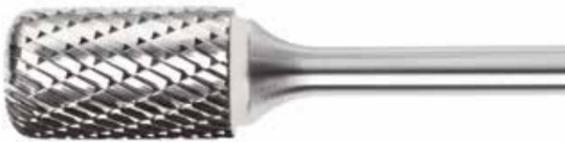
Fresa rotativa con raggio ad angolo in carburo di tungsteno sinterizzato, con raggio di taglio in testa al cilindro per un miglior controllo della fresa. Forza di taglio incrementale all'inizio dell'utilizzo della fresa; possibilità di riprodurre un raggio sul pezzo lavorato; riduzione della scheggiatura della fresa nei punti d'intersezione.
